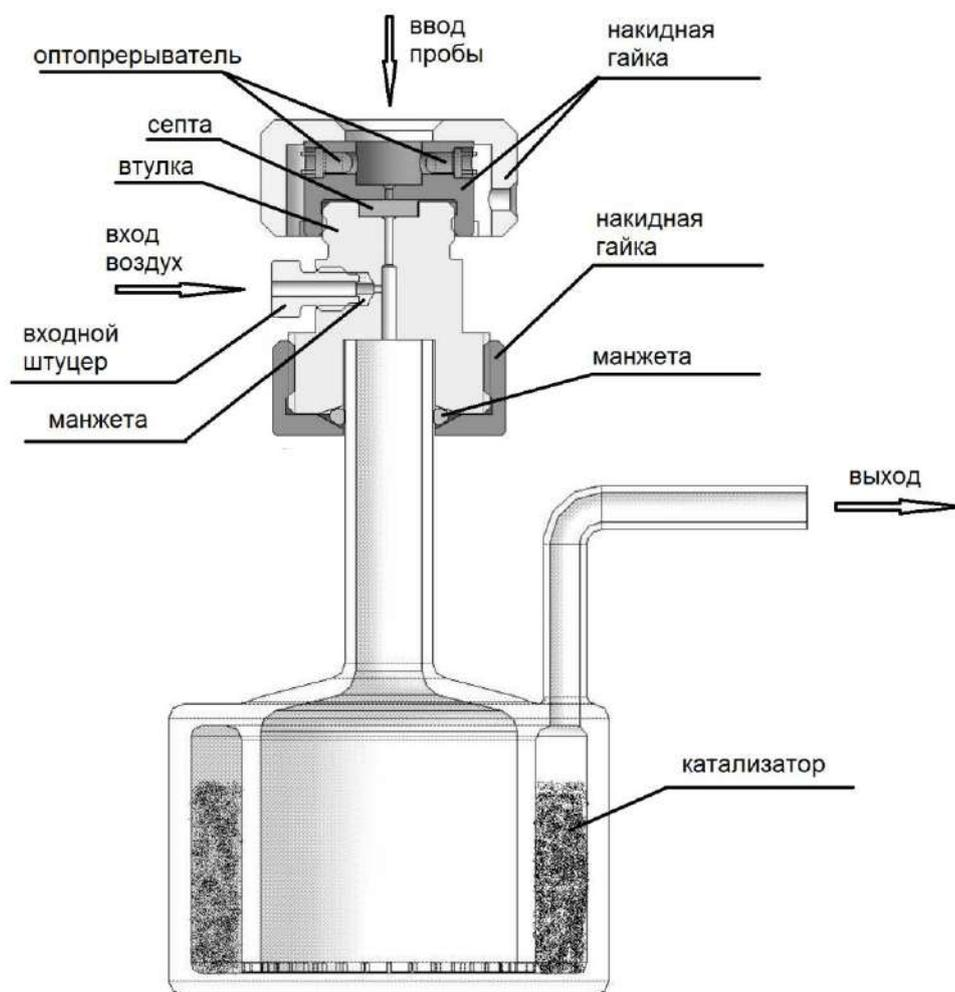
Рисунок 2.1. Реактор термокatalитический с устройством ввода проб.
