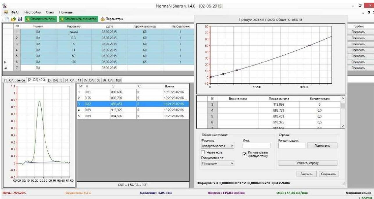
Рисунок 2.15 - Окно создания новой градуировки (при режиме измерения "ОА")
